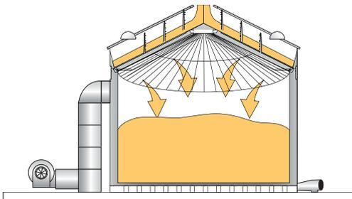
Lorsque le grain dans la chambre de séchage est sec, les trappes de vidange sont ouvertes (manuellement ou par système motorisé automatique) ; et le grain est déversé dans la chambre de ventilation et de stockage dans la partie basse de la cellule. Une fois le grain totalement écoulé, les trappes sont refermées, et le séchoir est prêt pour une nouvelle «fournée».
