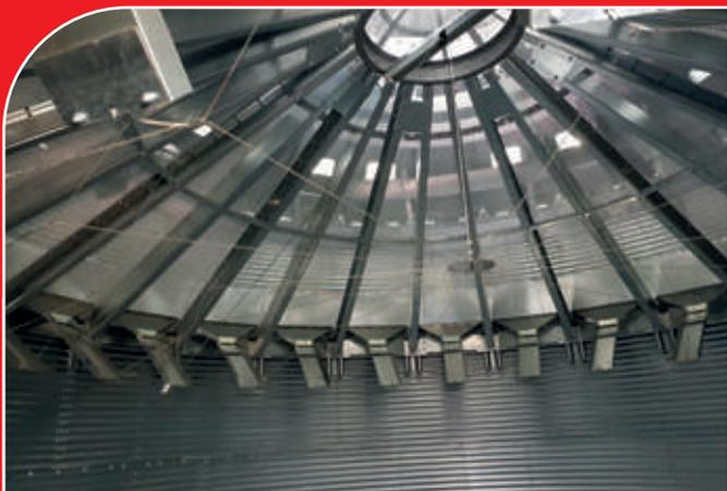
Trappes de vidange sous le plancher de séchage.
