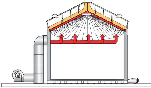
Le grain humide est transporté directement dans la chambre de séchage sous le toit de la cellule. Grâce aux anneaux de nivellement, le grain s'étale en couche mince uniforme de 70cm sur tout le plancher de séchage. Une telle couche est idéale pour un séchage rapide et efficace.
