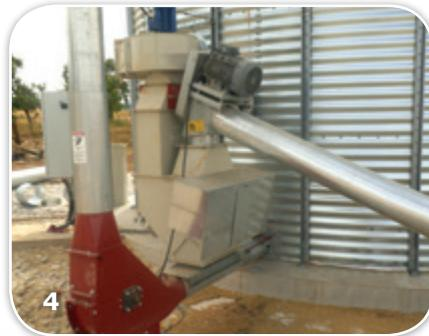
Les Boîtes à Cascade sont des appareils de dépoussiérage en circuit. En largeur 250mm ou 500mm, elles présentent **les caractéristiques suivantes :**
