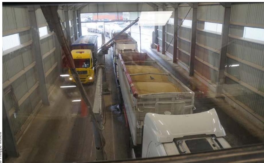
→ Au poste de pesage, les prélèvements d'échantillons sont pratiqués automatiquement par la sonde sur rail.
