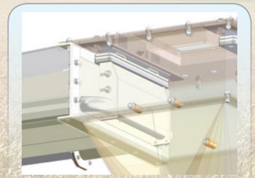
L'obturation du collecteur est effectuée par un système composé de 2 x 2 vérins à course faible (10mm). Lorsque le collecteur est en position fin de course, l'obturateur se déclenche et ferme intégralement l'ouverture du collecteur.
