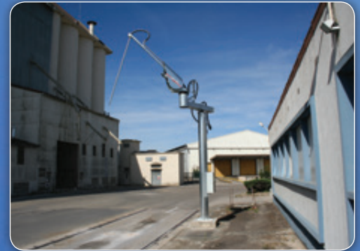
HERON Gyroscopique flächig deckende Probenentnahme mit Radien von 3300mm, 4100 mm oder 5000 mm
