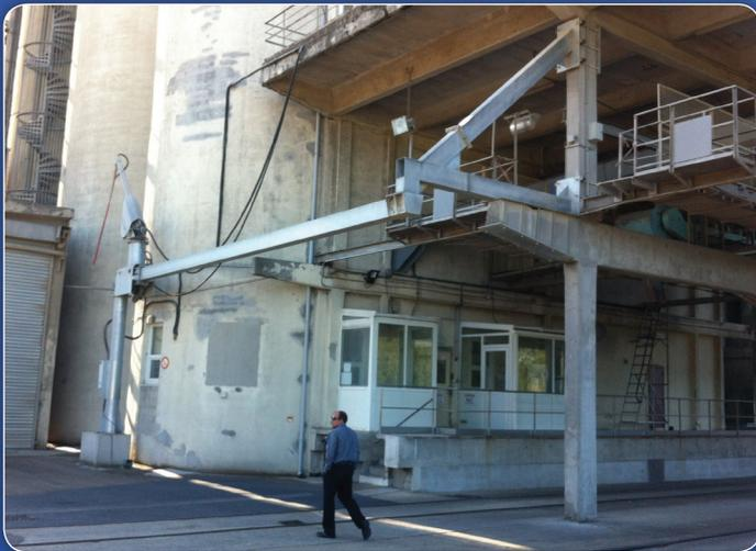
COBRA PREMIUM приподнятая допускает проезд транспортных средств под рельсом.
