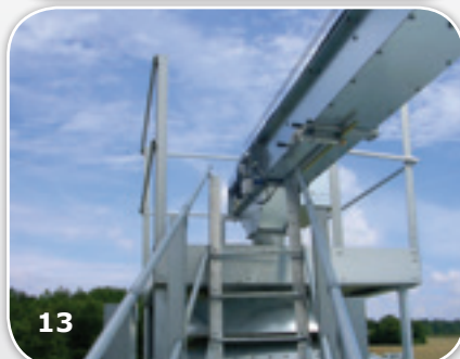
Echelle à crinoline Système de fermeture d'échelle Palier de repos pour cellule haute échelle amovible. (photo 8)
